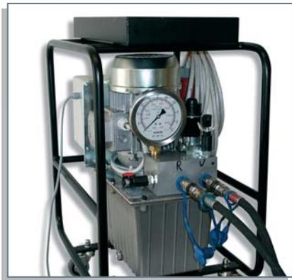
Im Apparatebau ist es von großem Vorteil, **dünnwandige Rohre** mit geringem Aufwand schnellstmöglichst aus dem Rohrboden zu entfernen. Das TP 79 wurde entwickelt, um mit einem extrem handlichen und beweglichen Gerät **Rohrauszieharbeiten**, insbesondere von dünnwandigen Rohren (z.B. im Kondensatorbau), schnell und bequem ausführen zu können.
